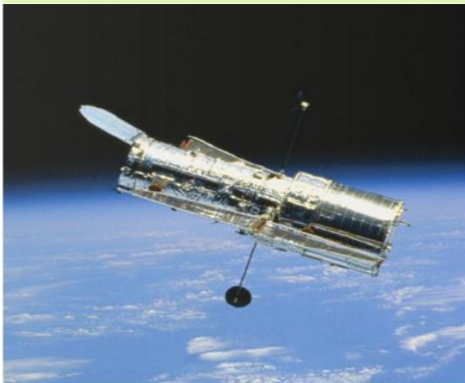
▲ Teleskop Hubble'a umieszczony jest na orbicie. Dzięki temu w obserwacjach nie przeszkadza ziemska atmosfera.
