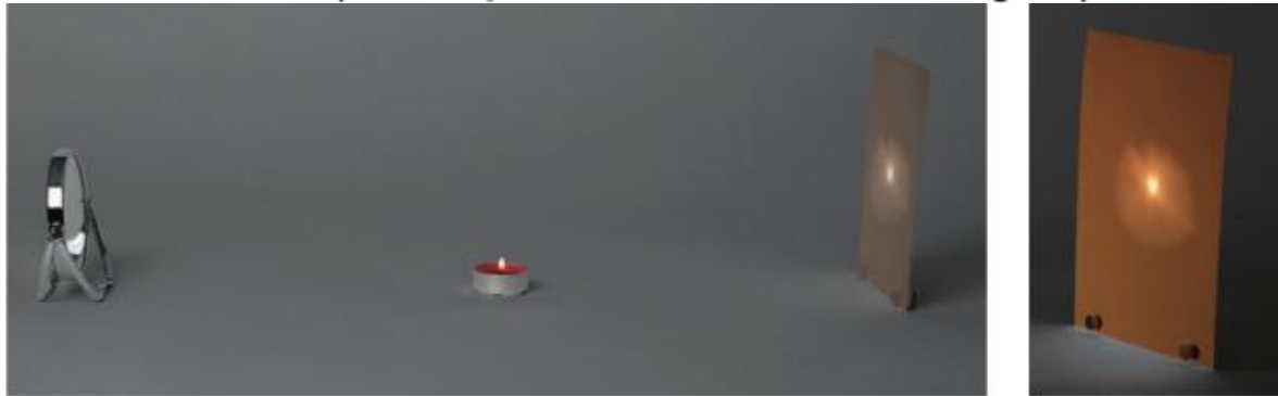
Obraz płomienia uzyskany na ekranie po jego odbiciu od zwierciadła wklęsłego.
