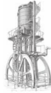
Dmuchawa napędzana silnikiem parowym z XIX w.
